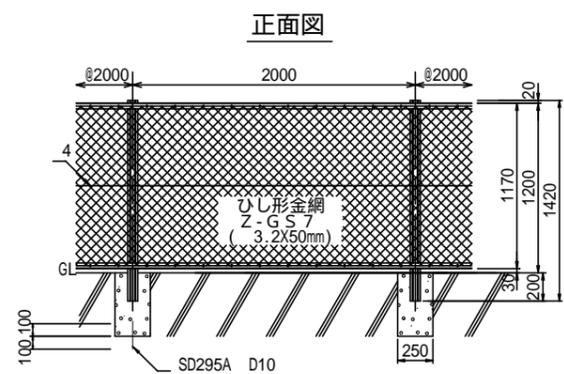
亜鉛めっき鉄線製ひし形金網に用いる材料は、JIS G3547のSWMGS-7に適合したものとす。
